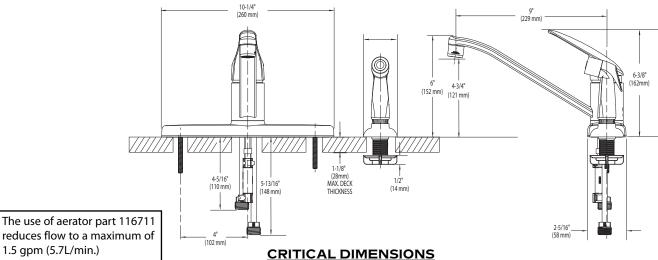
1.5 gpm (5.7L/min.)
