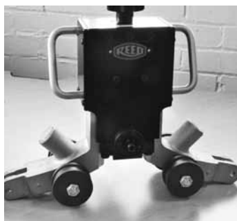
1. Empiece con la unidad base del motor 1. Commencez avec le bloc moteur de base
