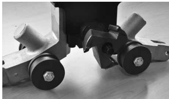
3. Apriete el Cortador de biseles de PVC sobre el Husillo largo 3. Serrez le coupe-tuyau en biseau pour PVC sur l'arbre
