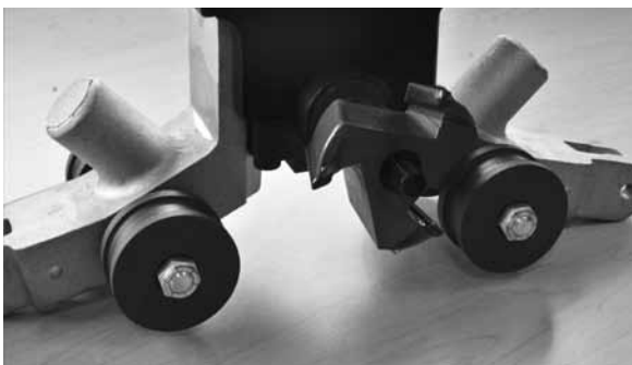
3. Ziehen Sie den Gehrungsschneider für PVC-Rohre am Langdorn fest. 3. Serrare la fresa conica per PVC sul mandrino lungo
