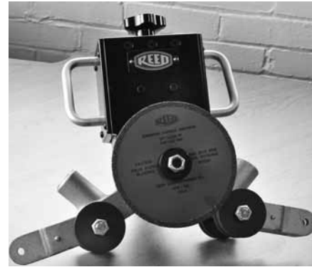
5. Schieben Sie Flansch Nr. 97066 auf und ziehen Sie anschließend Flexloc-Mutter Nr. 97543 fest. 5. Far scorrere la rondella flangiata 97066 quindi serrare il dado Flexloc 97543
