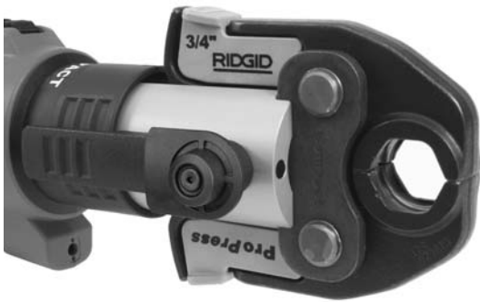
Figura 3 – Pasador de montaje completamente cerrado y bloqueado
