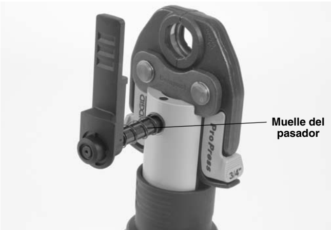
Figura 4 – Pasador de montaje completamente abierto y desbloqueado
