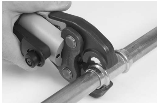
Figure 5 – Ouverture des mâchoires à ciseaux
