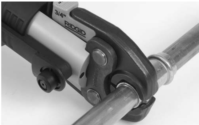
Figura 6 – Colocar la mordaza de tipo tijeras alrededor del acoplamiento
