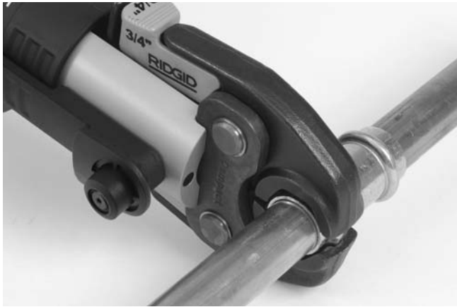
Figure 6 – Positionnement des mâchoires à ciseaux sur le raccord
