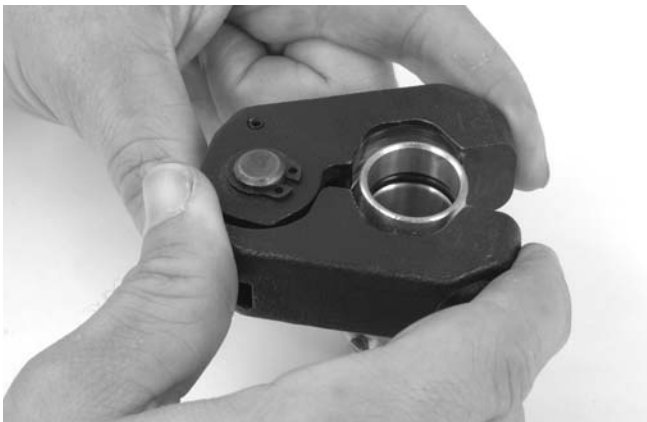
Figure 8 – Positionnement de la bague de sertissage sur le raccord
