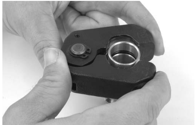
Figura 8 – Instalación del aro de sellado en el conector
