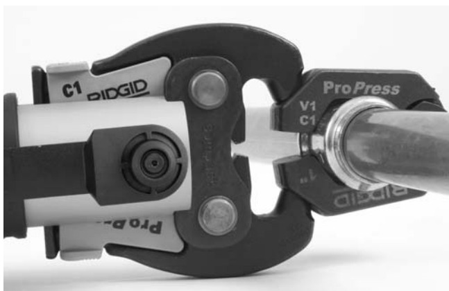
Figure 9 – Positionnement de l'actionneur sur la bague de sertissage
