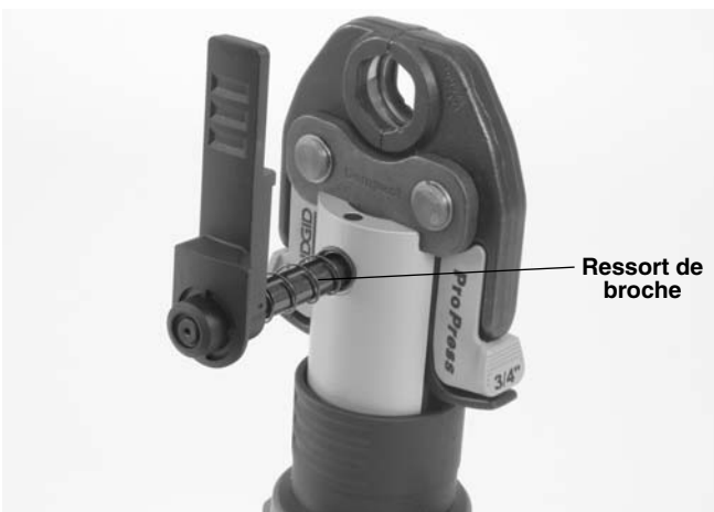
Figure 4 – Broche déverrouillée et entièrement ouverte
