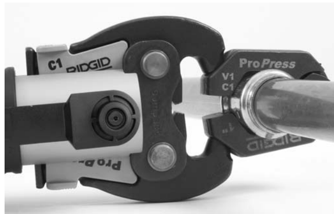
Figura 9 – Sujeción del accionador al aro de sellado
