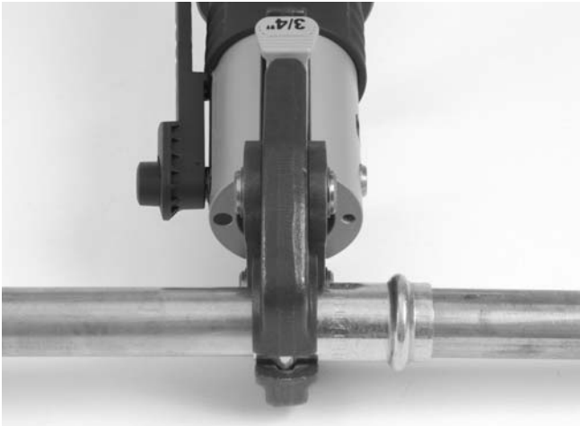
Figure 7 – Sertisseuse RP 200-B d'équerre avec le tuyau
