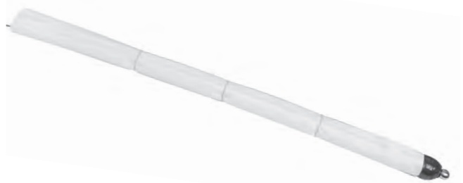
Figura 24 - El tubo de contención se fija con cinta adhesiva al extremo del obturador y se colocan bandas elásticas a intervalos de 12 pulgadas
