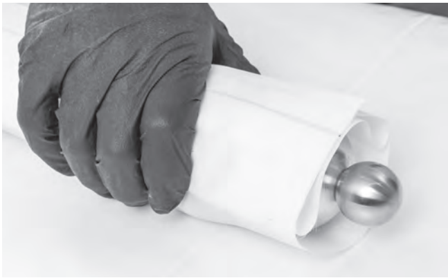
Figura 21 – El tubo de contención se pliega alrededor del obturador
