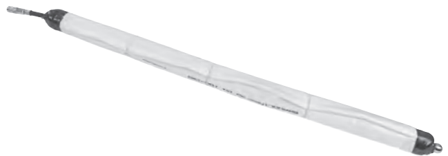
Figure 26 – Manchon gonflable avec revêtement, extrémités fixées par du ruban adhésif, élastiques doublés placés tous les 12 po
