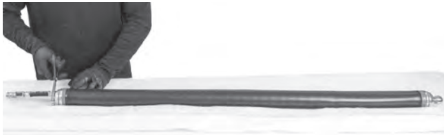
Figura 25 – Medición del revestimiento de contención
