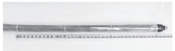
Figura 16 – Las bandas elásticas se colocan a intervalos de 12 pulgadas sobre la camisa del obturador
