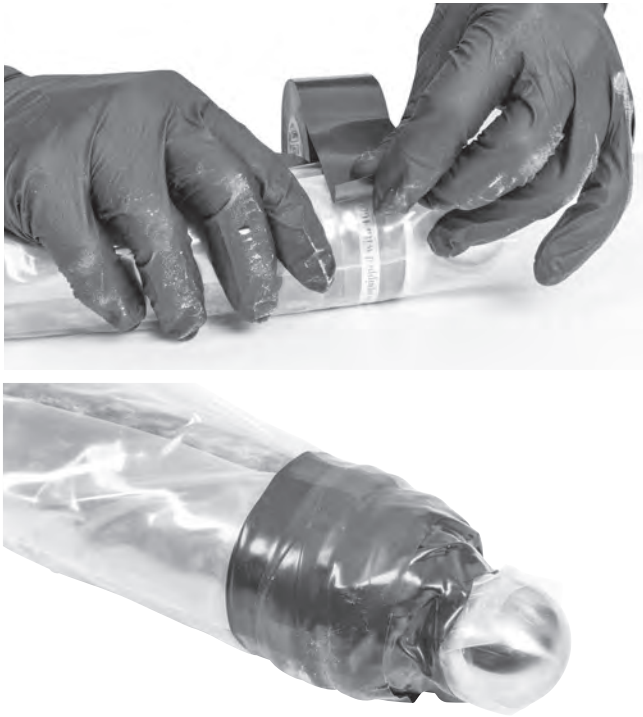
Figura 14 – La manga se pliega alrededor del obturador y se fija con cinta adhesiva
