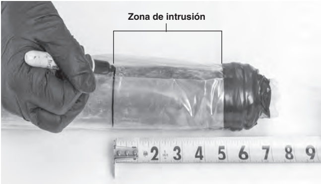
Figura 27 A – La zona de intrusión se marca con marcador sobre la camisa del obturador
