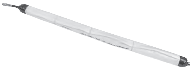
Figura 26 – El obturador con revestimiento de contención, con cinta adhesiva en los extremos, y bandas elásticas dobladas y colocadas cada 12 pulgadas
