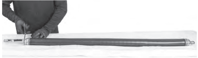
Figure 25 – Mesure du revêtement de confinement
