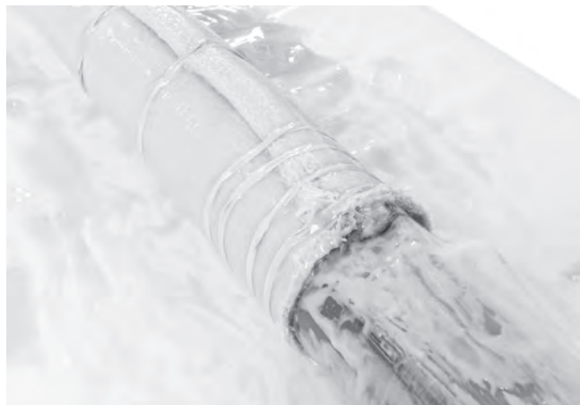
Figura 30 – Formación del doblez con el material del parche
