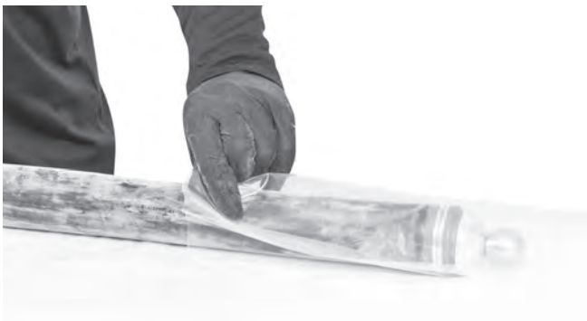
Figura 12 – Introducción del obturador dentro de la camisa
