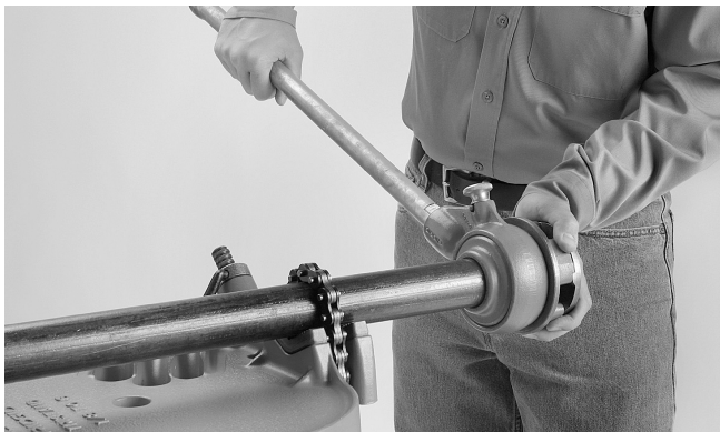
Figure 3 – Montage de la fileteuse sur le tuyau
